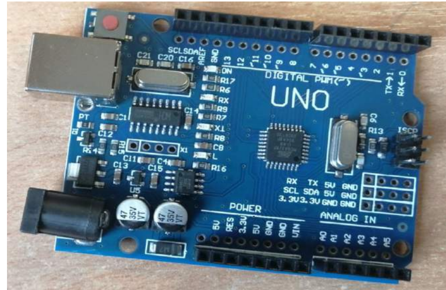
Плата контроллера Arduino Uno R3 (ATmega 328P / CH340G) – 1 штука Стоимость от 400 руб до 1000 руб.
